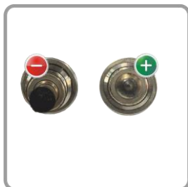
Vorher/ Nachher-Effekt Injektor nach 400 km gemischtem Fahrbetrieb (Stadt, Landstrasse, Autobahn)
